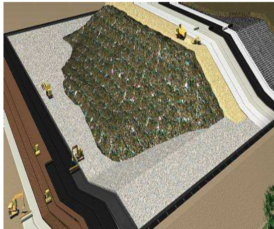
Figura 5.2-6: Secțiune printr-un depozit de deșeuri
