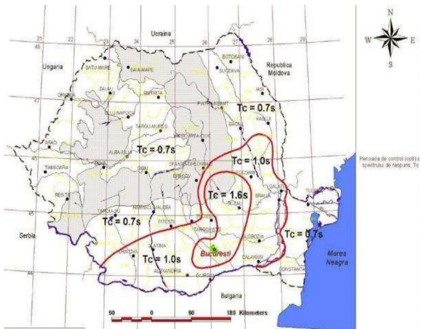
Fig.2. Zonarea teritoriului Romaniei in termeni de perioada de control (colt), T_c a spectrului de raspuns (extras din P 100/2013).
