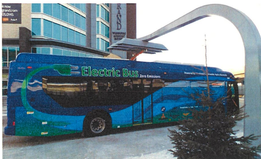
Figura 9. Sistem de incarcare a bateriilor autobuzului electric – pantograf (incarcare in statie)
